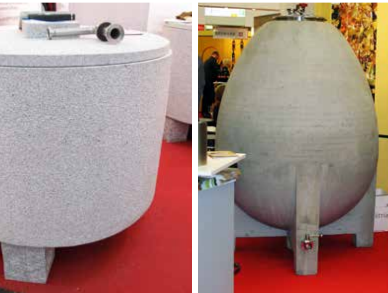
Резервуар из натурального камня и Бетонный резервуар в форме яйца, © Вальтер Кальцин
